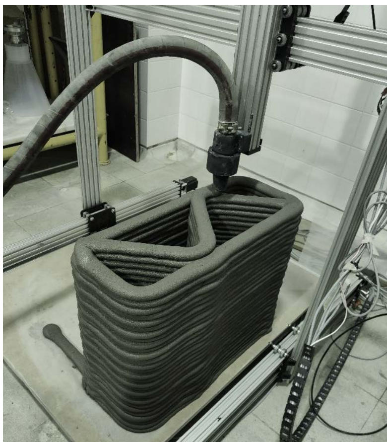
Impressora 3D de betão desenvolvida no âmbito do Projeto Europeu RECYCL3D
